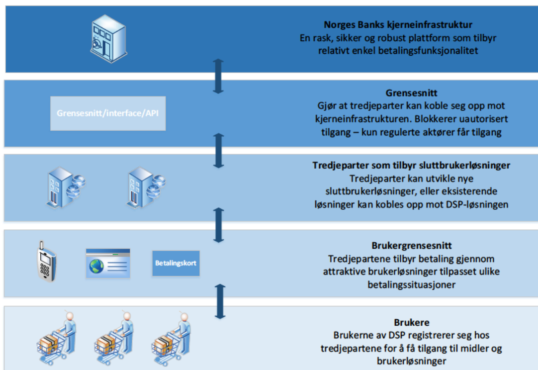
Figur 3. Overordnet skisse til arkitektur for et DSP-system
